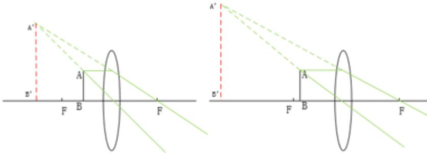
老年人通过放大镜看到了报纸 AB 的虚像  $A'B'$ ，由成像图可知无论眼睛如何移动，虚像  $A'B'$  的大小不会变化，因为虚像的大小只和报纸 AB 与放大镜的距离（即物距）有关，当物距增大时（在焦距  $F$  内），所成的虚像会变大。因此若报纸与放大镜不动，眼睛离报纸远一些，报纸上的字体大小不会变化；若想看到更大更清晰的字，应使放大镜离报纸远一些。故应保持报纸与眼睛不动，放大镜离报纸远一些，这样才能看到更大更清晰的字。
